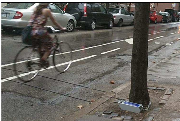
27. ábra - Szelektív gumitömlős detektor telepítési vázlata
