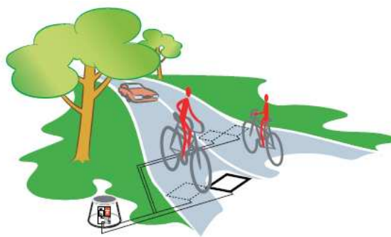
23. ábra - Szelektív hurokdetektorok telepítési vázlata
