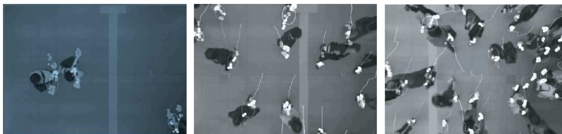
19. ábra – Irányvektorok számítása különböző gyalogos sűrűségek esetén forrás: Tracking pedestrian by using laser range scanners
