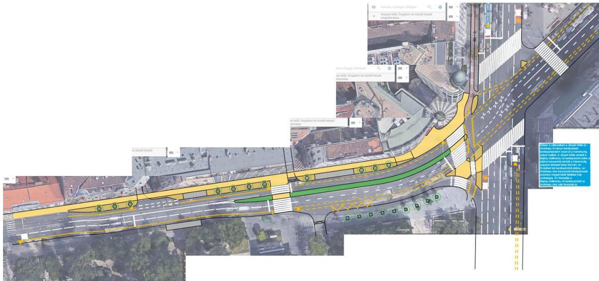
Mindkét változat esetén javasoljuk közvetett felállóhelyek kialakítását a közvetett balra kanyarodás segítéséhez.
